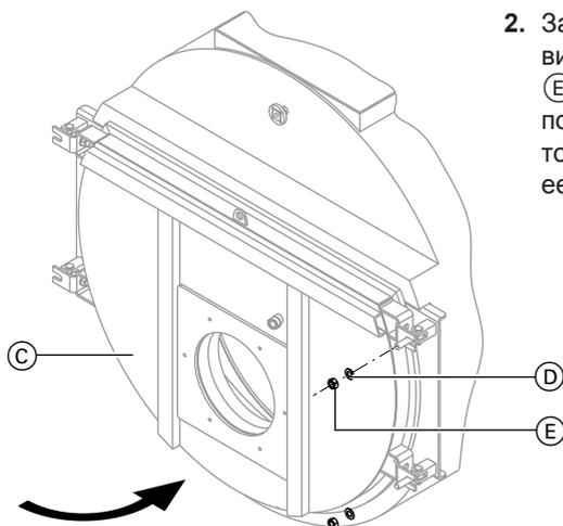
2. Закрыть дверь котла (C). Установить шайбы (D), накрутить гайки (E) и затянуть их крест-накрест, пока не будет обеспечено достаточное прилегание двери по всему ее периметру.
