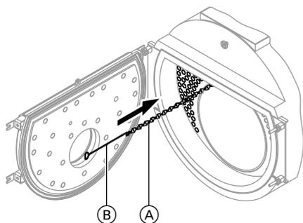
1. Вставить турбулизаторы (A) с использованием приспособление для извлечения турбулизаторов (B) до упора; турбулизаторы должны зафиксироваться.
