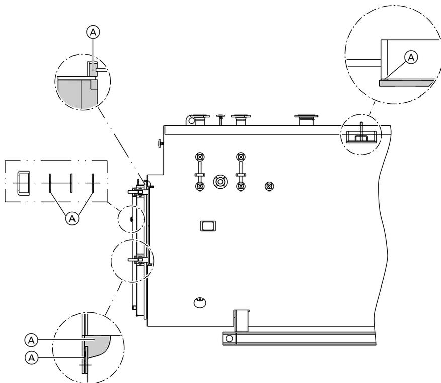
Проверить все уплотнения (A) и детали теплоизоляции на предмет отсутствия повреждений и прочность посадки.
