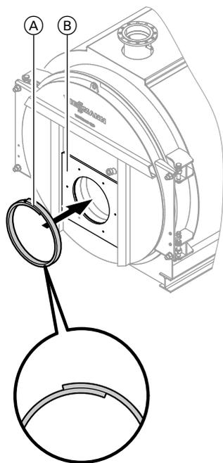
1. Наклеить уплотнительную ленту (A) на фланец котла (B).
